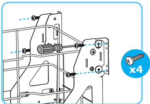
Зафиксируйте фасадные крепления выдвижной корзины (B, E) винтами (F) согласно рисунку.
