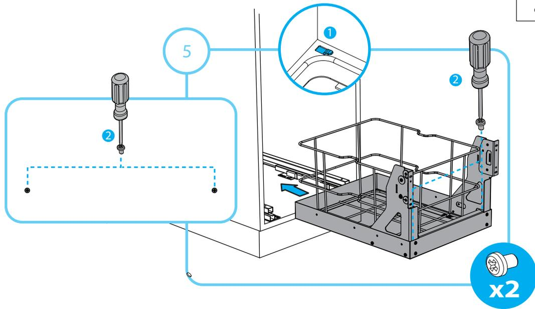
Выдвиньте вперед направляющие (D) и зафиксируйте выдвижную корзину (B,E) винтами (G).
